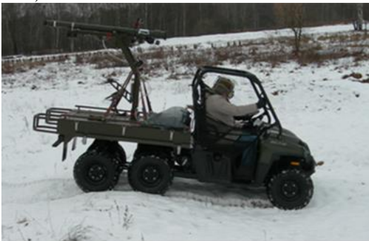
Rys. 3. Zestaw przeciwlotniczy Kusza: a) model, b) wyrzutnia na podwoziu pojazdu Ranger 8x8
