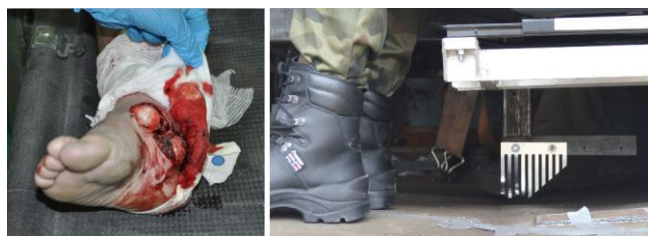
Rys. 1. Przykład obrażeń w obrębie stawu skokowego oraz metalowy grzebień pokazujący zakres odkształcenia płyty podłogowej
