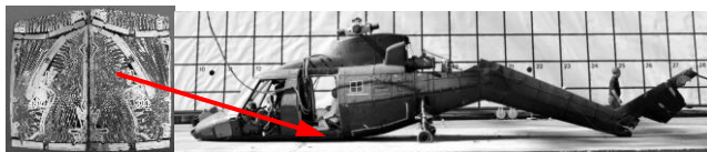
Rys. 2. Struktura typu sandwicz z rdzeniem w postaci plastra miodu [2]
