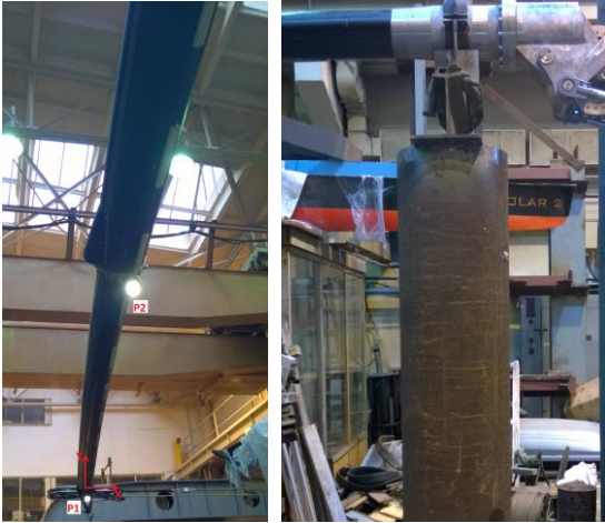
Rys. 2. Badania eksperymentalne, po lewej: konstrukcja w położeniu wyjściowym z oznaczonymi punktami pomiarowymi, po prawej: sposób podparcia konstrukcji
