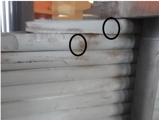
Rys. 5. Pęknięcia piór resoru na stanowisku badawczym
