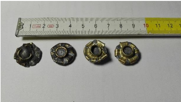
Rys. 3. Zdeformowane pociski .38 po uderzeniu w badane osłony
