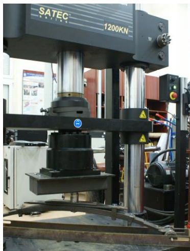
Rys. 2. Stanowisko do badań statycznych resoru [1]
