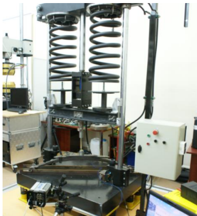
Rys. 5. Stanowisko do badań dynamicznych resoru [1, 3]
