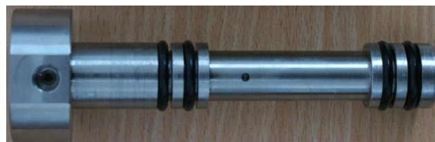
Rys. 1. Iniektor do szczelinowania próbek skalnych
