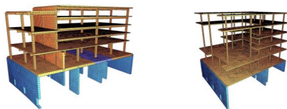
Rys. 4. Wizualizacja modeli obliczeniowych wybranych sekcji konstrukcji Forum Gdańsk z uwzględnieniem zabudowy na płycie stropowej
