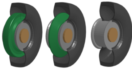
Rys. 3. Model układu a) ORFF – Run Flat o przekroju hiperbolicznym, b) ORFF – Run Flat o przekroju trójkątnym, c) układ bez wkładki Run Flat
