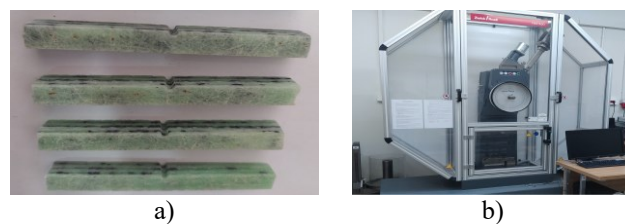
Rys. 1. Próbki z kompozytu K3 przygotowane do badań b) Młot wahadłowy typu Charpy'ego
