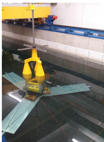
Rys. 1. Stanowisko do badań dynamiki PTW. Basen modelowy w Instytucie Oceanotechniki i Okrętownictwa, WIMiO, PG
