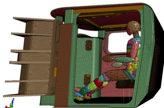
Rys. 1. Pełnowymiarowy model manekina wraz z fotelem i kabiną operatora
