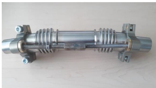
Rys. 1. Kompensator uniwersalny z uchwytem wymuszającym napięcie wstępne
