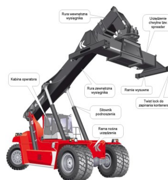
Rys. 1. Budowa urządzenia do przenoszenia kontenerów [5]
