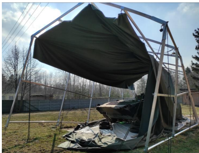
Rys. 3. Destrukcja namiotu spowodowana długotrwałym działaniem huraganu
