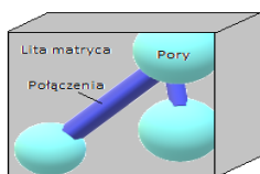
Rys. 6. Model odwzorowujący pory i połączenia między nimi w litym materiale
