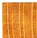
Rys. 2. Przekrój poprzeczny struktury drewna klonu [3]
