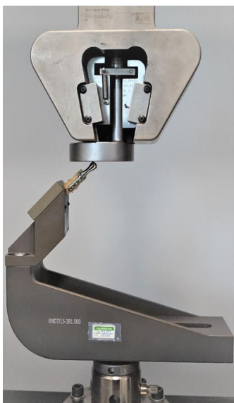
Rys. 1. Próbkę zainstalowaną w uchwycie zapewniającym anatomiczne położenie protezy
