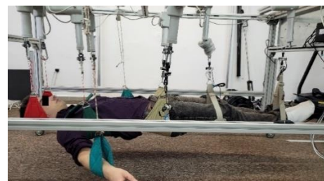
Rys. 1 Zautomatyzowane urządzenie do terapii w podwieszeniu
