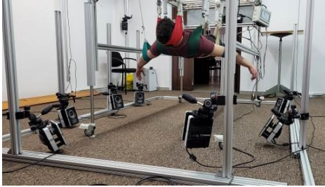
Rys. 2 Stanowisko pomiarowe do pomiarów w podwieszeniu
