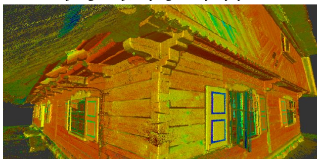
Rys. 2. Chmura punktów drewnianej chaty z bogatym detalem
