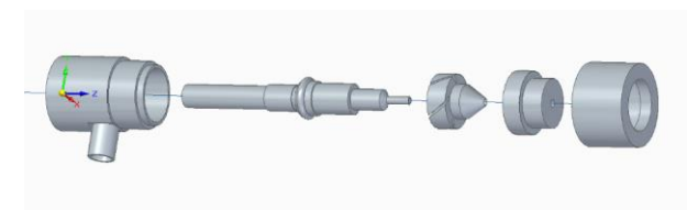
Rys. 2. Model geometryczny dyszy zamglawiającej
