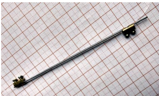
Rys. 1. Surowe włókno nawinięte na trzpień
