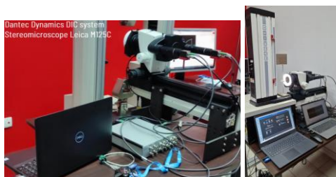
Rys. 3. Stanowiska pomiarowe z systemem cyfrowej korelacji obrazów do testów mikropróbek
